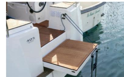
Die Badeplattform am Heck lässt sich über einen einfachen Schotzug abklappen, liegt unten aber immer noch relativ hoch über dem Wasserspiegel. Diese Höhendifferenz überwindet man mit der in der Heckklappe integrierten Teleskop-Badeleiter. Am Heck gibt es zudem ein Staufach für die Rettungsinsel. Die Abdeckung dafür ist allerdings schwer und muss im Notfall umständlich und als ganzes Element komplett entfernt werden.
