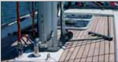
Il passaggio delle manovre a piede d'albero e infine il trasto della randa le cui scottine scorrono sotto traccia per evitare il passaggio all'interno dello spray hood
