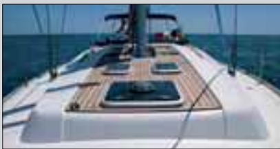
Dall'alto, una visione frontale della tuga, più alta rispetto ai modelli meno recenti e con un inserto in iroko al centro.
