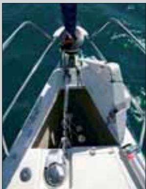
Il gavone dell'ancora con il verricello elettrico incassato. Manca un verricello di tonneggio
