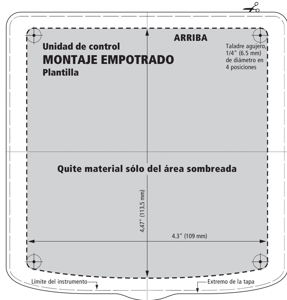
Plantilla de MONTAJE EMPOTRADO para Instrumentos ST60+
